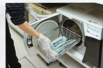
図6 プレポストバキューム式のオートクレーブは複雑な形状の器材でも十分な滅菌が可能。
