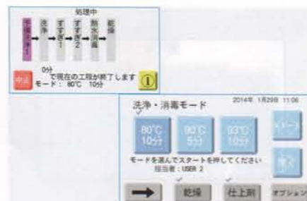
図2 ウォッシャーディスインフェクター「WD-150」の操作パネル。多彩なモード設定が可能。
