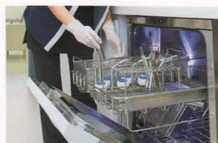
図4 洗浄するインストゥルメントをセット。ハンドピースは専用のアダプターに収納し、内部まで洗浄する。
